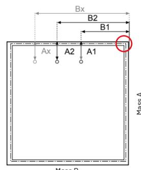
○ Ausgangspunkt Vermessung Griffbohrung
