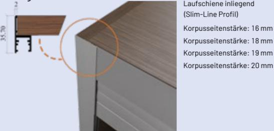
Laufschiene inliegend (Slim-Line Profil)
