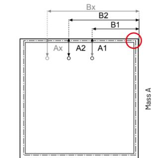
○ Ausgangspunkt Vermessung Griffbohrung
