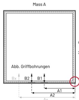
○ Ausgangspunkt Vermessung Griffbohrung
