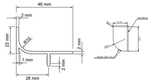
**Füllprofil für Vertios-Griffmulden L- und U-Form zur Befestigung von Elektrogeräten**
