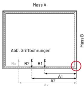
○ Ausgangspunkt Vermessung Griffbohrung
