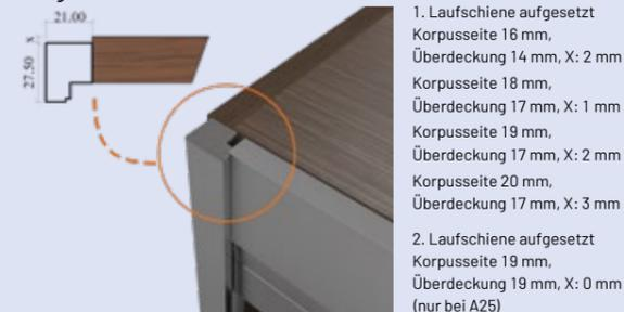
1. Laufschiene aufgesetzt
