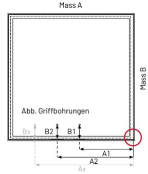
○ Ausgangspunkt Vermessung Griffbohrung
