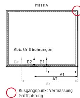
○ Ausgangspunkt Vermessung Griffbohrung
